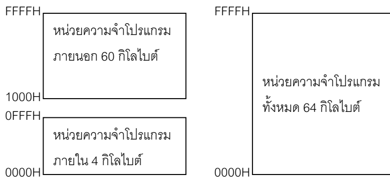
รูปที่ 1.8 แสดงการจัดพื้นที่หน่วยความจำโปรแกรมของชิปเบอร์ AT89C51
