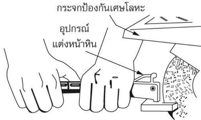
รูปที่ 1.4 แสดงการแต่งหน้าล้อหินเจียรระโนด้วยอุปกรณ์แต่งหน้าล้อหิน
