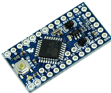
รูปที่ 1.8 แสดงบอร์ดอาร์ดูโน้ รุ่น Pro Mini 328 ขนาด 3.3 โวลต์
