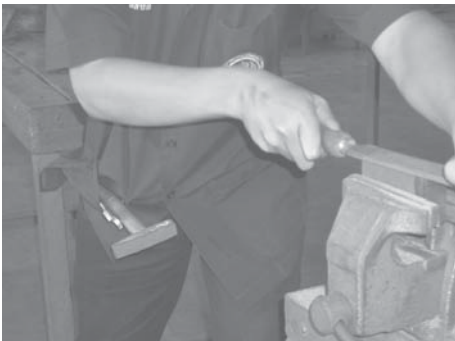
รูปที่ 1.15 เครื่องมืออื่นๆ อาจหล่นใส่เท้า ทำให้บาดเจ็บ
