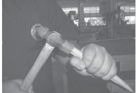
รูปที่ 1.18 เศษสกัดดอกอาจกระเด็นถูกผู้ปฏิบัติงานได้
