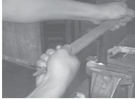
รูปที่ 1.14 ปลายตะไบอาจทิ่มมือ ทำให้ได้รับบาดเจ็บ
