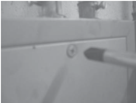
รูปที่ 1.9 การใช้ไขควงปากแฉกไขสกรูปากแฉก
