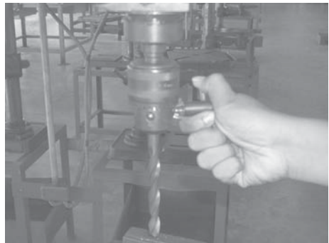
รูปที่ 1.2 การใช้จำปาขันหัวจับดอกสว่าน
