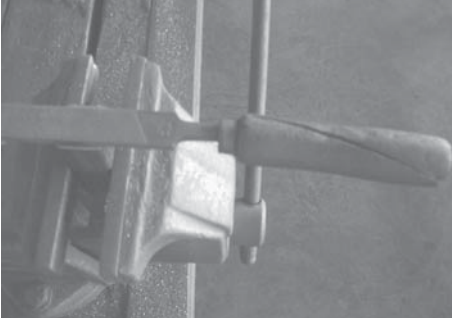
รูปที่ 1.17 ด้ามตำตะไบแตก เวลาใช้งานอาจหนีมือได้
