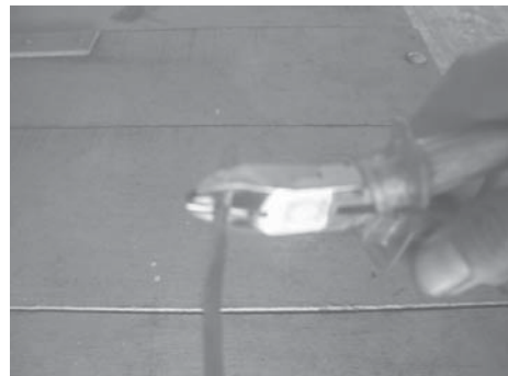
รูปที่ 1.4 การใช้คีมตัดด้านข้างตัดสายไฟฟ้า
