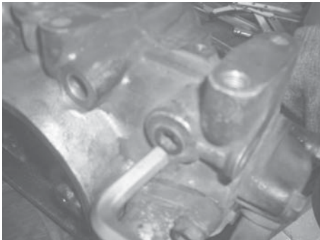
รูปที่ 1.7 การใช้ประแจแอลขันสกรู ที่มีร่องหกเหลี่ยม
