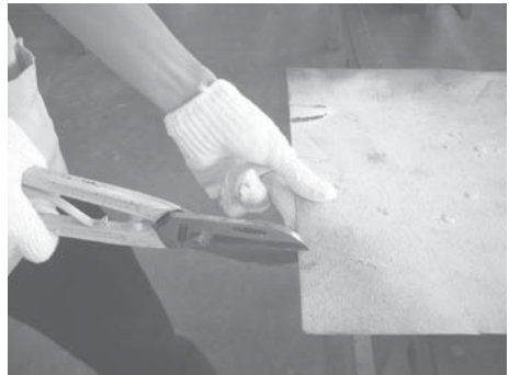
รูปที่ 1.10 การใช้กรรไกรปากตัดตรงตัดโลหะแผ่นบาง
