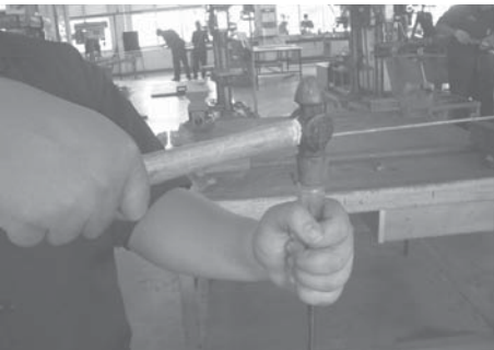
รูปที่ 1.19 ด้ามไขควงอาจแตก และกระเด็นถูกผู้ปฏิบัติงานได้
