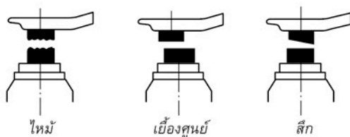
รูปที่ 2.13 สภาพบกพร่องของหน้าทองขาวแบบต่างๆ
