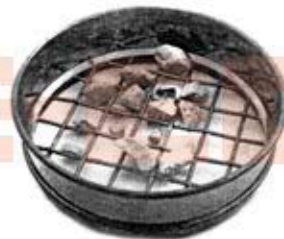
(ข) เม็ดหินและทรายที่ค้างบนตะแกรงแต่ละขนาด
