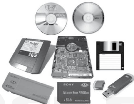
รูปที่ 1.8 แสดงตัวอย่างอุปกรณ์หน่วยความจำสำรอง
