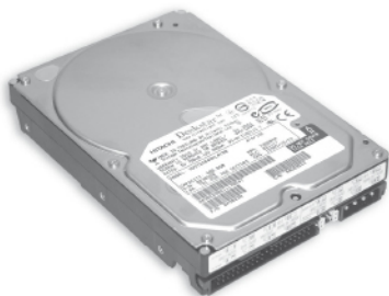
รูปที่ 1.12 แสดงตัวอย่าง Hard Disk Drive
