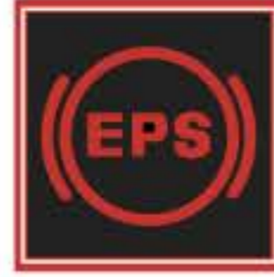
รูปที่ 1.13 รถยนต์ที่ติดตั้งพวงมาลัยเพาเวอร์แบบใช้ไฟฟ้า จะมีไฟเตือนติดอยู่ที่แผงหน้าปัด
