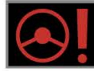
รูปที่ 1.13 รถยนต์ที่ติดตั้งพวงมาลัยเพาเวอร์แบบใช้ไฟฟ้า จะมีไฟเตือนติดอยู่ที่แผงหน้าปัด
