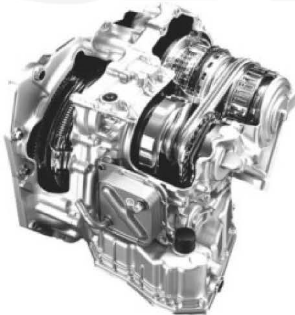
รูปที่ 1.7 เกียร์อัตโนมัติแบบซีวีที (Continuous Variable Transmission, CVT) ข้อดีของเกียร์อัตโนมัติแบบนี้ก็คือเมื่อเกียร์เปลี่ยน รอบเครื่องยนต์จะนิ่ง ทำให้การขับขี่นุ่มนวล
