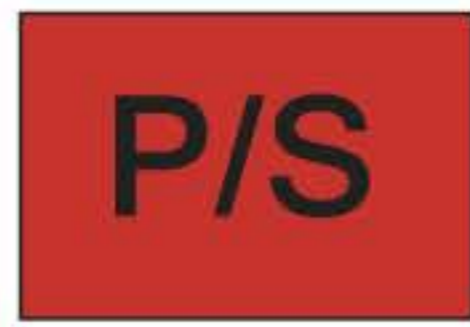
รูปที่ 1.13 รถยนต์ที่ติดตั้งพวงมาลัยเพาเวอร์แบบใช้ไฟฟ้า จะมีไฟเตือนติดอยู่ที่แผงหน้าปัด
