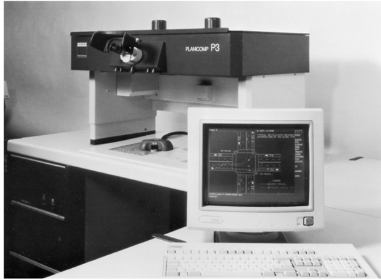
รูปที่ 1-30 เครื่อง Zeiss Planicomp P3 ซึ่งเป็นเครื่อง Stereo Plotter ในยุค Analytical Photogrammetry (ดัดแปลงจาก Lillesand et al., 2008)
