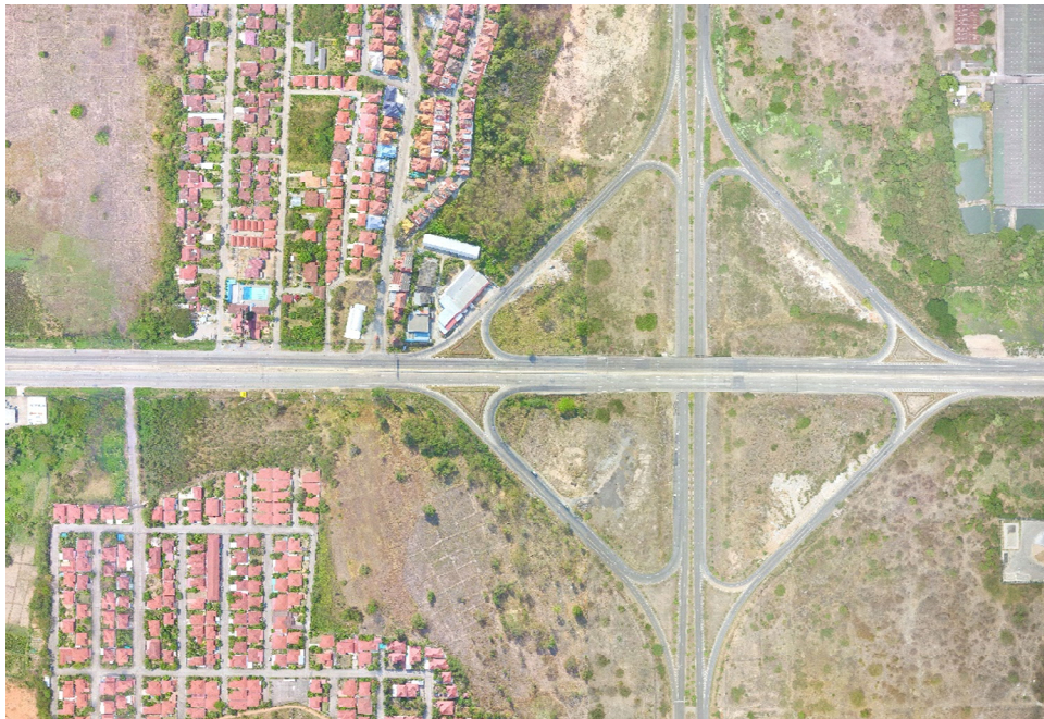
รูปที่ 1-4 ผลลัพธ์จากโดรนในงาน UAV Photogrammetry ในรูปแบบของแผนที่ภาพถ่ายออร์โธบริเวน ทางเลี่ยงเมือง จ.ขอนแก่น (ดัดแปลงจาก สนข., 2561)
