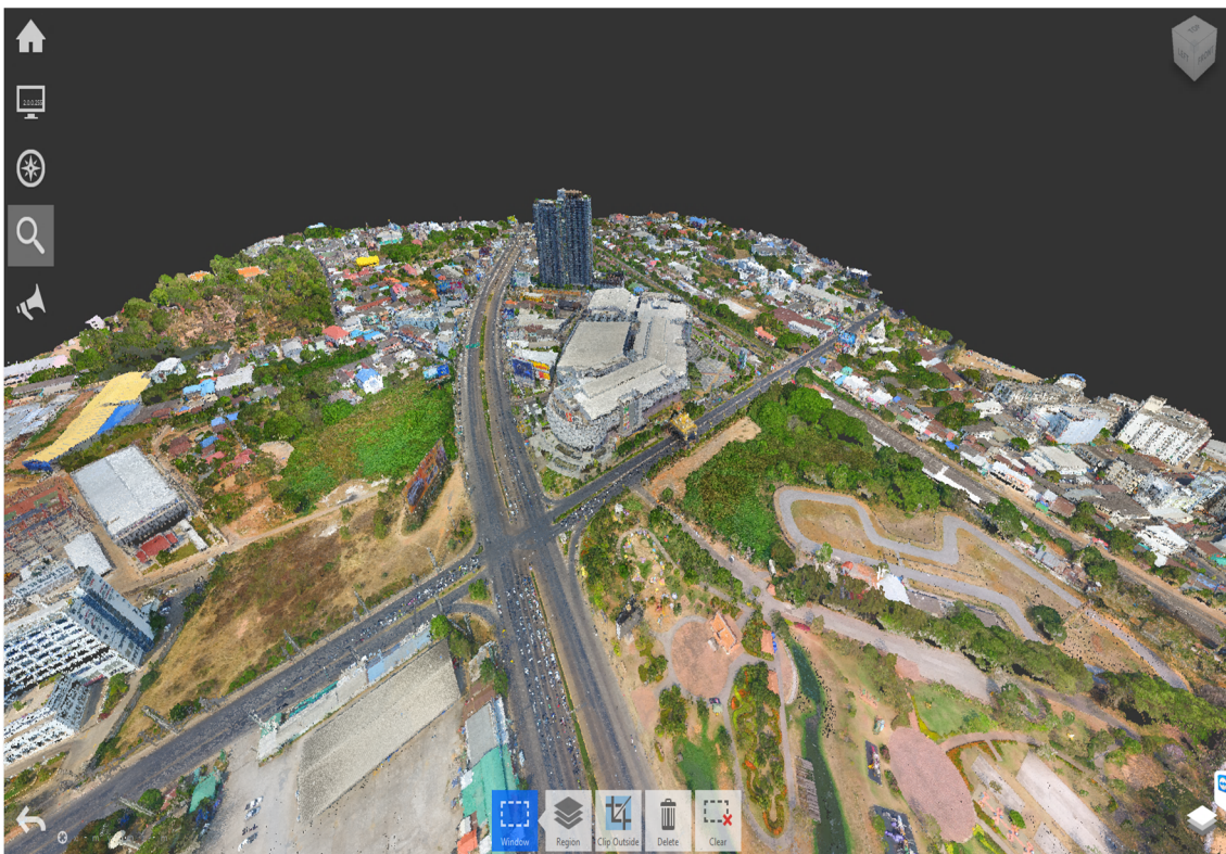
รูปที่ 1-8 ตัวอย่างข้อมูลพอยต์คลาวด์ (Point Cloud) ที่ได้จากการรังวัดด้วยภาพถ่าย (ดัดแปลงจาก สนข., 2561)
