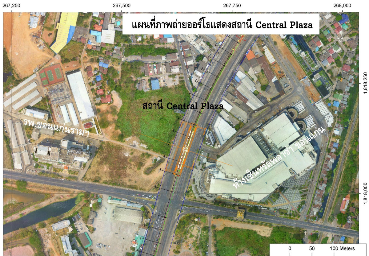
รูปที่ 1-11 ตัวอย่างของแผนที่ภาพถ่ายออร์โธสีบริเวณเมืองสี่แยกเซนทรัล อำเภอเมือง จังหวัดขอนแก่น ซึ่งได้นำมาใช้ในการออกแบบสถานีรถไฟรางเบาในเมืองขอนแก่น (ดัดแปลงจาก สนข., 2561)
