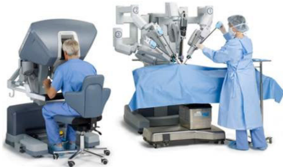
รูปที่ 1-6 เครื่อง da Vinci Xi – Surgical System สำหรับใช้ในการผ่าตัดในวงการแพทย์ ทั้งนี้เพื่อสามารถผ่าตัดเอาชิ้นส่วนต่างๆ ภายในร่างกายได้อย่างแม่นยำ และเกิดการบาดเจ็บระหว่างการผ่าตัดที่น้อยที่สุด (ดัดแปลงจาก Nakagawa, 2017)
