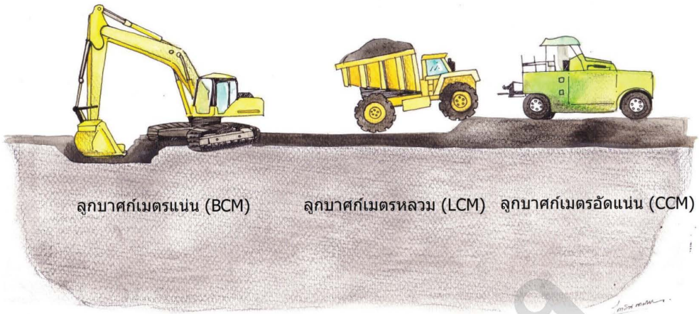
ภาพที่ 1.2 การเปลี่ยนแปลงของปริมาตรวัสดุเนื่องจากรานดิน
