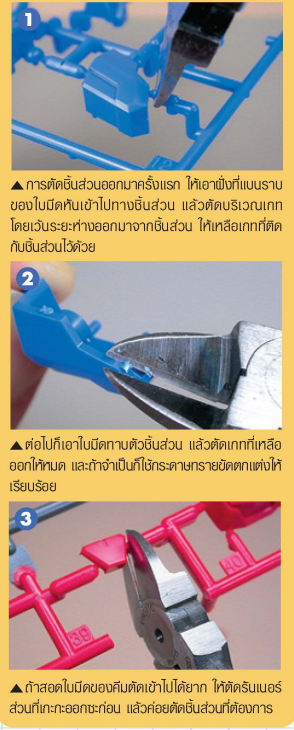
Sharp Compact Nipper ◀ เป็นคีมตัดสำหรับพลาสติกโมเดล ที่มีประสิทธิภาพสูง แต่ราคาถูก ไบรด์จะบางและแบนคม ใช้ตัดส่วนที่ละเอียดมากๆ ได้ดี (MINESHIMA / 1,050 เยน)
