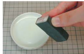
▲วิธีการใช้ขี้ผึ้งฐานของกระดาษทรายน้ำ คือนำไปพันกับตัวรอง (ในตัวอย่างนี้คือยางลบ) แล้วนำไปจุ่มน้ำก่อน จากนั้นค่อยทำการขัด
