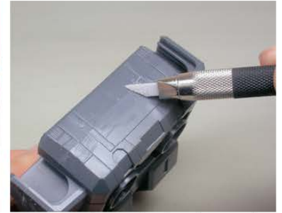
▲ การชุบแบบใส่ใบมีดเพื่อแต่งพอร์ซให้เรียบ ใบมีดขนาดนี้จะมีพลังตัดที่ดี และใช้ได้มันคงกว่าดอก
