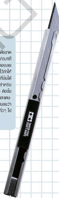
▲ ในการตัดวัสดุเช่นแล้ว คัตเตอร์ ใบมีดจะดันกลับเข้าที่เดิม
