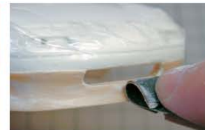
▲ในการตกแต่งผิวสีนั้น บางครั้งก็ไม่ต้องใช้ตัวรองเลย แต่ใช้ประยี่ห้อจากแรงยึดของกระดาษทรายที่จับแน่นกับผิวสีแทน
