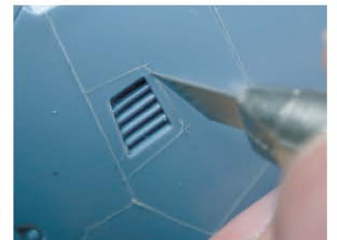
▲ ทำตำหนิลงไปสำหรับการแกะลายเส้น และยังใช้ขัดแกะลายเส้นแบบละเอียดๆ ได้ก็ด้วย
