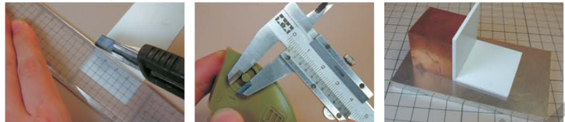
▲ นี่เป็นการนำไม้บรรทัดไปกดเพื่อขีดเส้นพลาสติก ไม้บรรทัดพลาสติกนั้น ให้ใช้ส่วนที่มีเหล็กแปะอยู่ด้านหลังนะ ▲ การวัดเส้นผ่านศูนย์กลางของแท่งกระบอกหรือแกนนี้ให้วัดด้วยวิธีวงเวียนจะดีที่สุด จะทำให้วัดได้ถูกต้องและแม่นยำกว่าการเอาไม้บรรทัดไปทาบกับลำตัวนะ ▲ นี่เป็นการนำสิ่วโลหะกับแปะไม้โลหะที่เป็นไม้โกดั้นส่วนประกอบของไม้โกดั้นอยู่ จะแม่นยำกว่าแปะกับสิ่วโลหะหรือแปะกับสิ่วไม้
