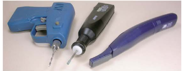
▲ หัวเจียน, สว่าน, แชนเดอร์รี่ส่วนข้างถูกที่วางขายอยู่สำหรับงานแบบจำลอง ไม้แบบไม้กึ่งจะเป็นแบบใช้พลังงานแบตเตอรี่และแบตเตอรี่กำลังเบา:มี ข้อการใช้งานแบบไร้สายก็เป็นข้อดีของมันเป็นจะไม่เหนียวในการตัดงานหนักหรือใช้งานในระยะยาวก็จริง แต่โดยปกติแล้ว แชนเดอร์รี่ก็ใช้งานได้อย่างเพียงพอแล้ว
