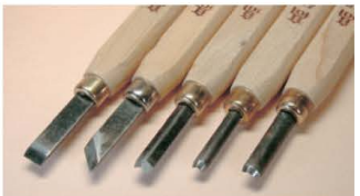
▲ ปลายมีดแต่ละประเภทของมีดแกะสลัก จากทางซ้ายคือ มีดแบน, มีดแกะสลัก (ใช้ตัดชิ้นรูป), มีดสามเหลี่ยม, มีดกลม (เล็ก), มีดกลม (ใหญ่)
