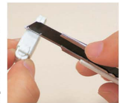
▲ ตั้งใบมีดแล้วสอดใบมีดแบบเขียงเพื่อทำการตัด จะลดความหนาใบมีดลงเล็กน้อย แล้วใช้ใบมีดกลิ้งลงไปเพื่อวัสดุไปตามหัวสอยๆ กลิ้งไป
