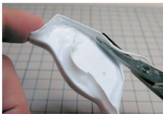
◀ ในการตัดส่วนเกินของแวลคิมแพร์กนั้นกรรไกรจะมีประโยชน์มากเลย จะปรับน้ำหนักการออกแรงได้ง่ายมาก และตัดตรงก็เปลี่ยนแบบในการตัดได้ก็ด้วยนั่นเอง
