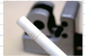
▲ ใช้ Pipe Cutter มาแกะลายเส้นบนแถงพลาซติก ไม่เพียงแต่ใช้ในการตัด หรือทำตัวกันเท่านั้น ยัง สามารถใช้ในการแกะลายเส้นได้อีกด้วย
