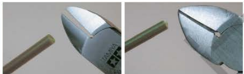
▲ เปรียบเทียบรอยตัดของใบมีด ทางซ้ายจะเป็นแบบสำหรับตัดพลาสติก, ส่วนทางขวากจะเป็นคีมตัดแบบทั่วไป สำหรับพลาสติกนั้น จะเปรียบเทียบกับแบบทั่วไปจะกลายเป็นรูปร่างไม่เรียบ
