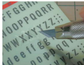
▲ แวกการตัดดีคอลล ที่ต้องใช้การหันแบบมีดอย่างละเอียดอ่อนนั้นเป็นจุดที่ใบมีดแบบนี้ดี
