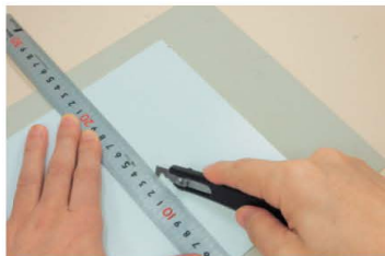
▼ ใช้ปัดคัตเตอร์วางตัดโดยการวางที่มุมของไม้ สำหรับในการแกะลายเส้นพลาสติกแบบอื่น ยังใช้กับการสร้างแบบพลาสติกก็ได้
