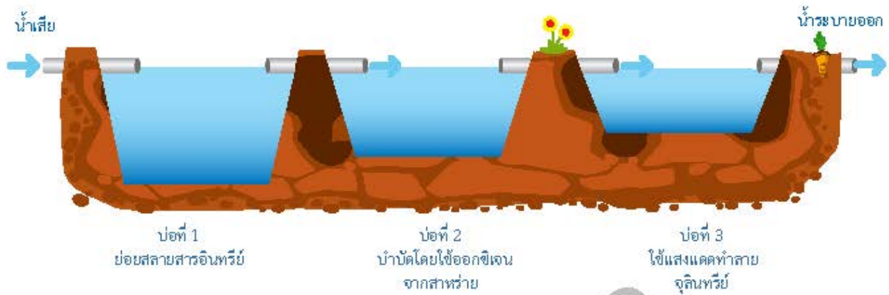
รูป 1.3 วิธีการบำบัดน้ำเสียแบบบ่อปรับเสถียร
