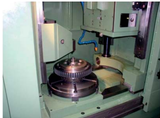
รูปที่ 1.19 ลักษณะการทำงานของ เครื่องไสผลิตฟันเฟืองซีเอ็นซี (ที่มา : http://www.directindustry.com )
