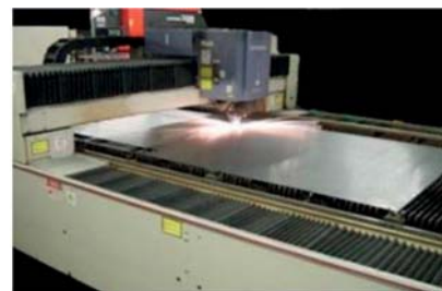
รูปที่ 1.45 ลักษณะการทำงานของเครื่องตัดแผ่นโลหะด้วยเลเซอร์
