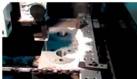
รูปที่ 1.41 ลักษณะการทำงานของ เครื่องตัดโลหะด้วยเส้นลวด (ที่มา : http://www.youtube.com )
