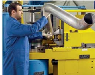
รูปที่ 1.39 ลักษณะการทำงานของ เครื่องดัดท่อเอ็นซีและซีเอ็นซี (ที่มา : http://www.miller-sts.com )
