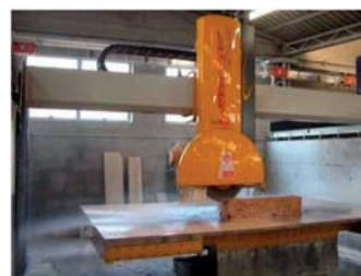
รูปที่ 1.33 ลักษณะการทำงาน of เครื่องเลื่อยอัตโนมัติ (ที่มา : http://www.breton.it )
