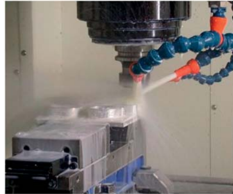
รูปที่ 1.13 ลักษณะการทำงานของเครื่องกัด CNC
