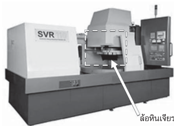
รูปที่ 1.27 เครื่องเจียรระโนขึ้นงานหมุนรอบตามแนวราบ CNC (CNC Rotary Vertical Surface Grinder Machine) (ที่มา : http://www.shi.co.jp )
