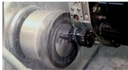
รูปที่ 1.10 ลักษณะการทำงานของ เครื่องกลึง CNC (ที่มา : http://www.youtube.com )
