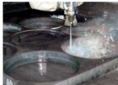
รูปที่ 1.49 ลักษณะการทำงานของเครื่อง CNC Water Jet Cutting Machine (ที่มา : http://waterjet-cutting.blogspot.com )
