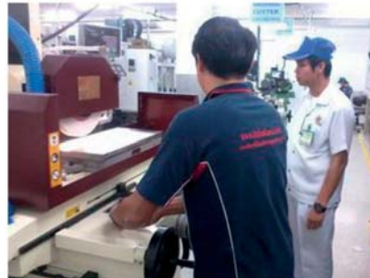
รูปที่ 1.25 ลักษณะการทำงานของ เครื่องเจียระไนราบ CNC (ที่มา : http://www.iitgroup.in.th )
