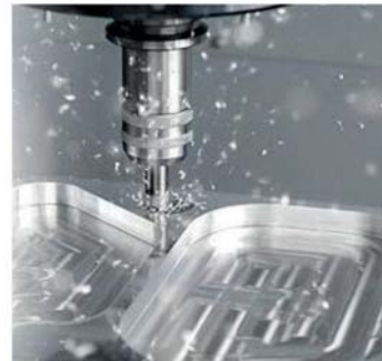
รูปที่ 1.15 ลักษณะการทำงานของ เครื่อง Machining Center
