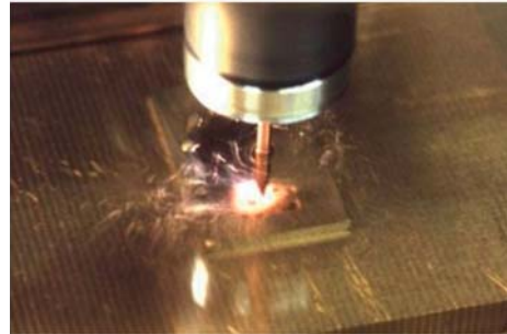
รูปที่ 1.43 ลักษณะการทำงานของเครื่อง EDM
