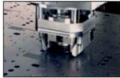
รูปที่ 1.51 ลักษณะการทำงานของ เครื่องเจาะกระแทกคอมพิวเตอร์ (ที่มา : http://www.iconmachinetool.com )
