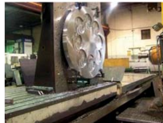
รูปที่ 1.55 ลักษณะการทำงาน of เครื่องคว้านรู ขนาดใหญ่ (CNC Boring Machine)
