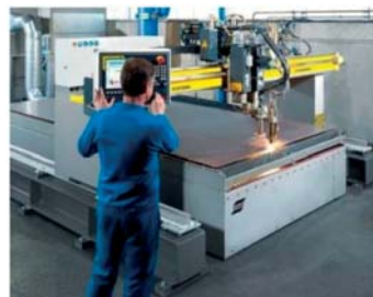
รูปที่ 1.47 ลักษณะการทำงานของเครื่อง CNC Plasma Cutting Machine (ที่มา : http://trade.indiamart.com )
