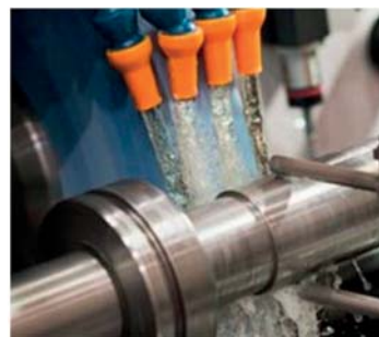
รูปที่ 1.23 ลักษณะการทำงานของเครื่องเจียรระโนกลม CNC (ที่มา : http://www.okuma.com )
