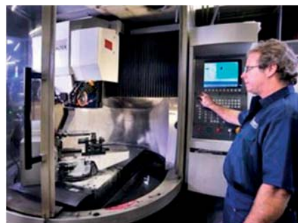
รูปที่ 1.37 ลักษณะการทำงานของเครื่องลับ เครื่องมือตัด
