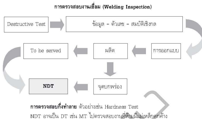
รูปที่ 1.2 ไดอะแกรมแสดงความสัมพันธ์ระหว่างการตรวจสอบแบบทำลายกับแบบไม่ทำลายสภาพ
