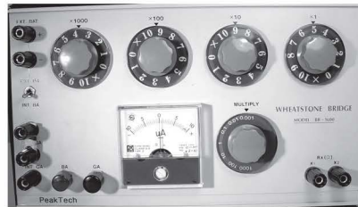
รูปที่ 1.3 เครื่องวัดไฟฟ้าแบบชี้ค่าศูนย์
