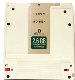
รูปที่ 1.17 แมกเนโต ออปติคัลดิสก์ เป็นสื่อจัดเก็บข้อมูลที่นำเทคโนโลยีแสงและแม่เหล็กมาใช้ด้วยกัน
