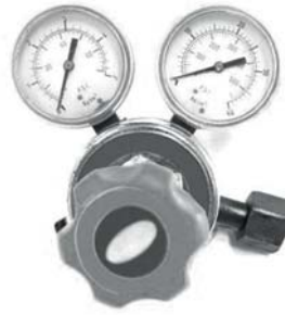
รูปที่ 1.15 แสดงเครื่องควบคุมความดันแก๊สแบบขั้นตอนเดียว
