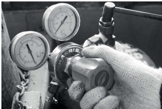
รูปที่ 1.6 แสดงการปรับความดันใช้งานของอะเซทิลีน
