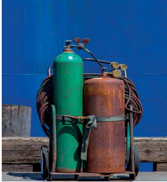
รูปที่ 1.3 แสดงการวางถังบรรจุออกซิเจนและอะเซทิลีนบนรถเข็น
