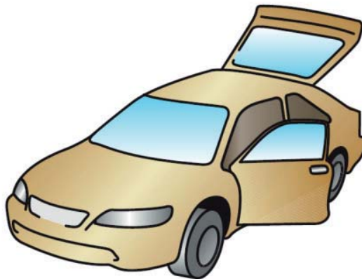
รูปที่ 1.3 รูปแบบของโครงสร้างและตัวถังรถยนต์แบบลิฟต์แบ็ค
