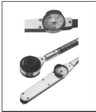
รูปที่ 1.18 ลักษณะของประแจวัดแรงบิดแบบหน้าปัด
