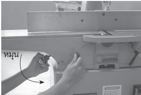
รูปที่ 2.4 แสดงการปรับมือหมุนเพื่อเลื่อนแท่นหลัง
