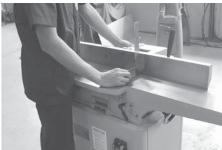
รูปที่ 2.10 แสดงการปรับรั้วให้ตั้งฉากกับแทน
