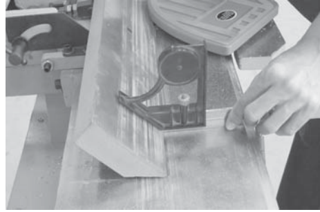
รูปที่ 2.16 แสดงการใช้ฉากเป็นตรวจสอบความเอียงของรั้ว
