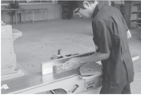
รูปที่ 2.12 แสดงการป้อนไม้เข้าหัวตัด
