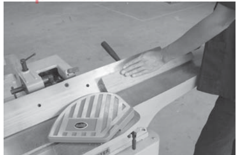
รูปที่ 2.18 แสดงการจับและป้อนไม้เข้าหัวตัด
