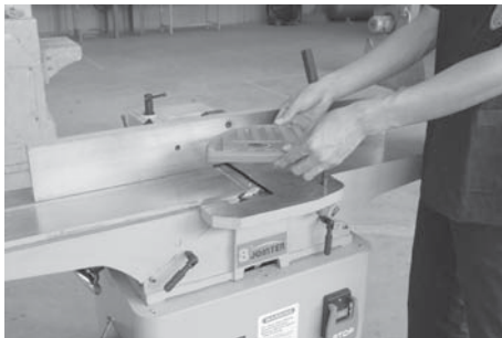
รูปที่ 2.21 แสดงการถอดครอบคลุมหัวตัดออก
