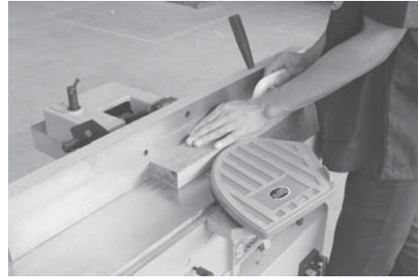
รูปที่ 2.13 แสดงการไสไม้ด้านที่ติดกันกับด้านที่ไสครั้งแรก
