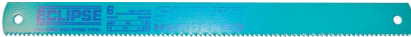
รูปที่ 1.9 แสดงลักษณะของใบเลื่อยสำหรับเครื่องเลื่อยกลแบบชัก
