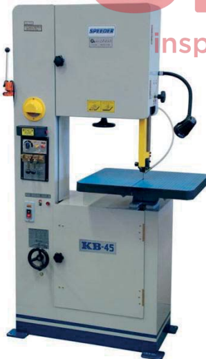
รูปที่ 1.3 แสดงลักษณะของเครื่องเลื่อยกลสายพานตั้ง
