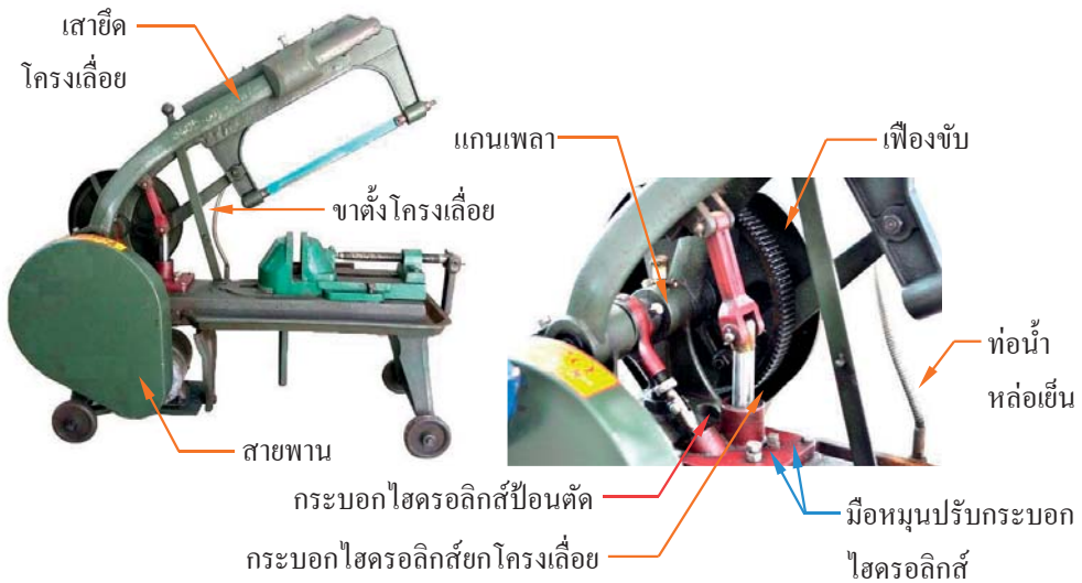
รูปที่ 1.5 แสดงส่วนประกอบของเครื่องเลื่อยกลแบบชัก
