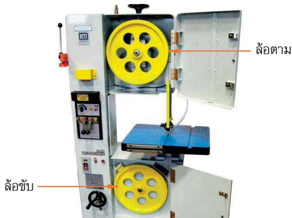
รูปที่ 1.8 แสดงส่วนประกอบภายในของหัวเครื่อง (ที่มา : http://www.alibaba.com/ วันเข้าถึง 12 กรกฎาคม 2561)
