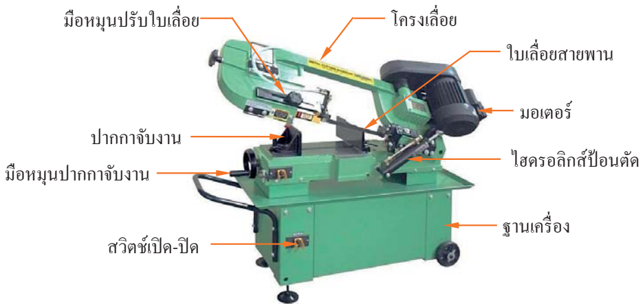
รูปที่ 1.6 แสดงส่วนประกอบของเครื่องเลื่อยกลสายพานนอน
