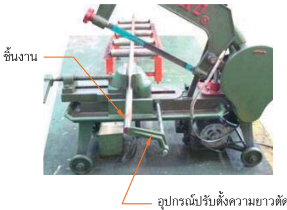
รูปที่ 1.19 แสดงลักษณะของการใช้อุปกรณ์ปรับตั้งความยาวตัด (ที่มา : อำนาจ ทองแสน, 2561)
