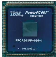
รูปที่ 1.10 ซีพียูตระกูล Power PC ของ IBM ซึ่งใช้สถาปัตยกรรมแบบ RISC
