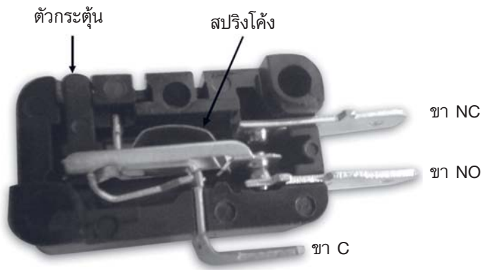
รูปที่ 2.12 ตัวกระตุ้นถูกกดหน้าสัมผัสอยู่ในตำแหน่ง NO
