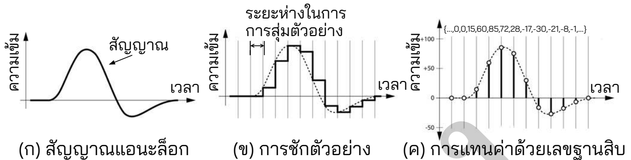
ภาพประกอบที่ 1.7: การแปลงข้อมูลจากแอนะล็อกเป็นดิจิทัล
