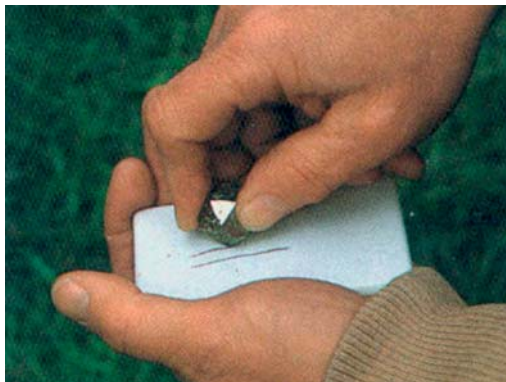
รูปที่ 1.1 การทดสอบโดยการขูดก้อนแร่บนแผ่นกระเบื้องเพื่อทดสอบสีผงของแร่
