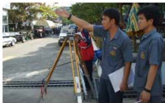
รูปที่ 1.17 แสดงการตั้งกล้องระดับผิงอาคาร
