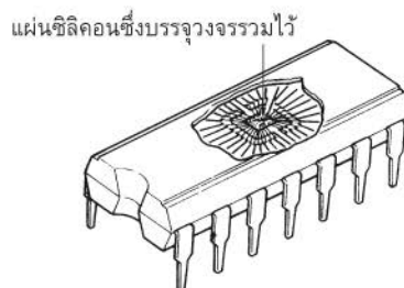
รูปที่ 1.23 ภาพตัดแสดงวงจรรวมหรือไอซี
