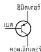
รูปที่ 1.12 การต่อสารกึ่งตัวนำให้เป็นทรานซิสเตอร์แบบ NPN และแบบ PNP
