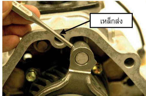
รูปที่ 1.24 การใช้งานของเหล็กส่ง ถอดสลักก้ามปูเปลี่ยนเกียร์
