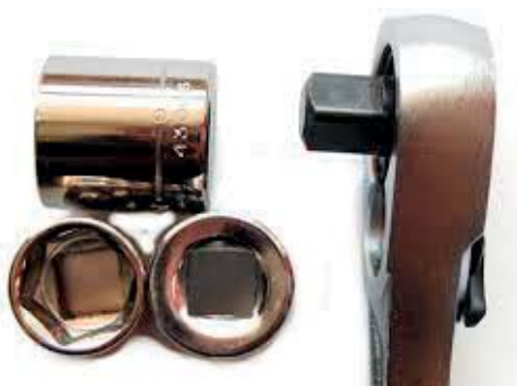
รูปที่ 1.19 เลือกด้ามต่อให้มีขนาด สวมพอดีกับลูกบ็อกซ์
