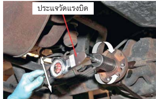
รูปที่ 1.38 การปรับพรีโหลด ด้วยประแจวัดแรงบิด
