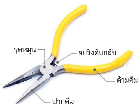
รูปที่ 1.6 คีมปากแหลมหรือคีมปากจิ้งจกและการใช้คีมปากแหลมปลดปลิ้นล็อกขาเกียร์
