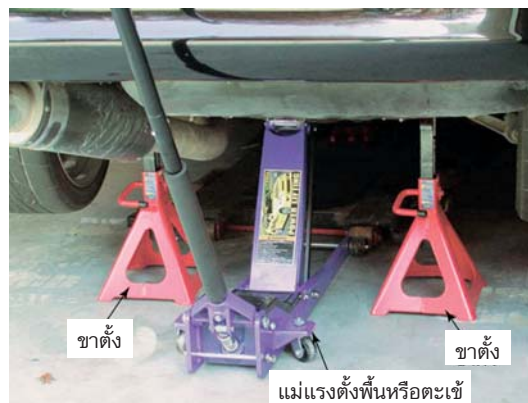
รูปที่ 1.41 การใช้แม่แรงตะเซ่ร่วมกับขาตั้งตำแหน่งรองรับขาตั้งบริเวณจุดแข็งแรงของตัวถังรถยนต์
