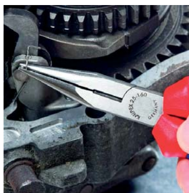
รูปที่ 1.6 คีมปากแหลมหรือคีมปากจิ้งจกและการใช้คีมปากแหลมปลดปลิ้นล็อกขาเกียร์
