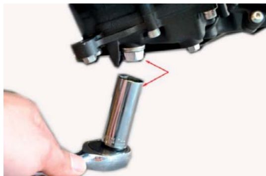
รูปที่ 1.18 เลือกลูกบ็อกซ์ให้มีขนาด ที่พอดีกับหัวนอตและโบลต์
