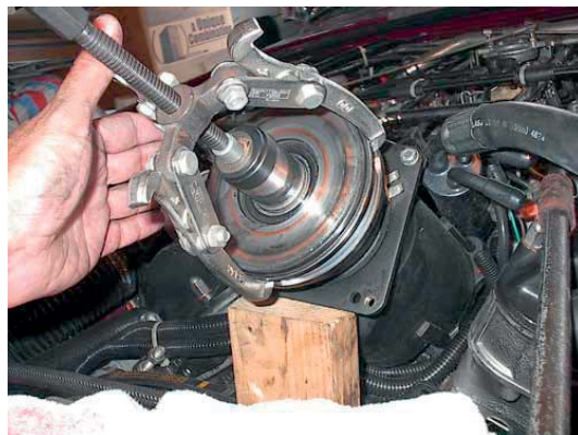
รูปที่ 1.31 แสดงการใช้เครื่องมือดูดลูกปืน
