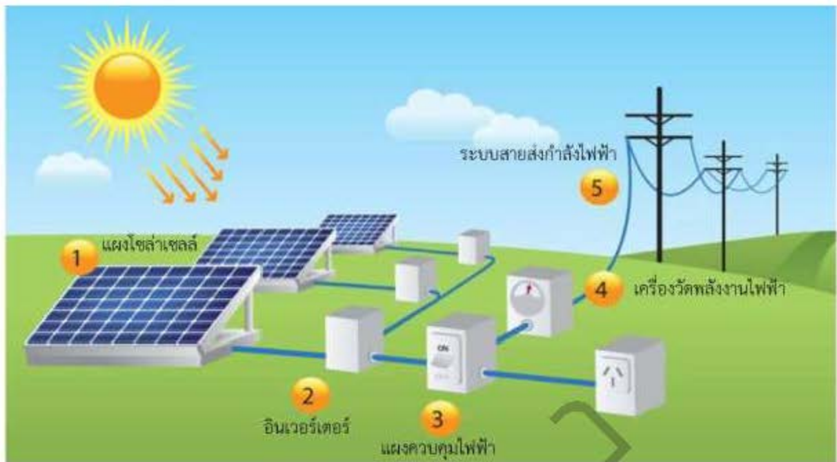
รูปที่ 2.10 แสดงการใช้พลังงานจากแสงอาทิตย์ผลิตพลังงานไฟฟ้า (Solar farm)
