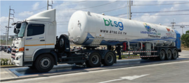
รถบรรทุกที่เต็ม LNG เต็มถึง สามารถเดินทางได้ระยะทางมากถึง 1,400 กม. เมื่อเทียบกับเครื่องยนต์ดีเซลที่เดินทางได้ 1,200 กม. รถบรรทุกที่ใช้ LNG 500 กม. และรถบรรทุกไฟฟ้า 300 กม.
