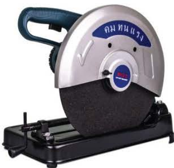
รูปแสดงลักษณะเครื่องตัดไฟเบอร์ขนาด 14 นิ้ว แปรงถ่านและใบตัด (ที่มา : http://www.rpam.co.th/product/216/B-355 )
