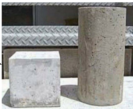
รูปที่ 1.10 การเก็บตัวอย่างเพื่อทดสอบกำลังอัดคอนกรีต
