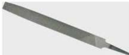
ตะไบแบน ใช้กับโลหะที่เป็นรูปทรงแนวนอนหรือแนวตั้ง
