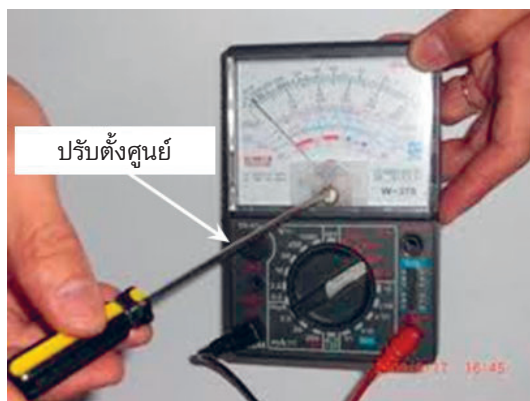
รูปที่ 1.21 การปรับตั้งค่าศูนย์บนสเกลวัด
