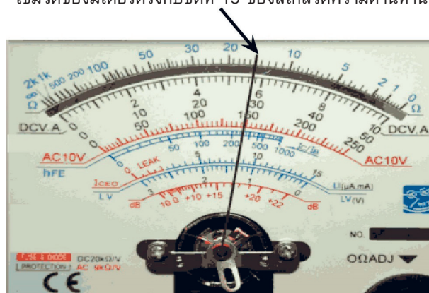
รูปที่ 1.8 เข็มวัดของมิเตอร์ตรงกับขีดที่ 15
