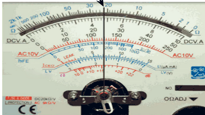
รูปที่ 1.12 ค่าแรงเคลื่อนไฟฟ้ากระแสตรงที่อ่านได้บนสเกล 24 โวลต์
