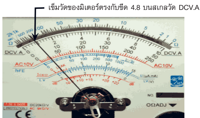
รูปที่ 1.20 ค่ากระแสไฟฟ้าที่อ่านได้บนสเกลเท่ากับ 48\ \mu\text{A}
