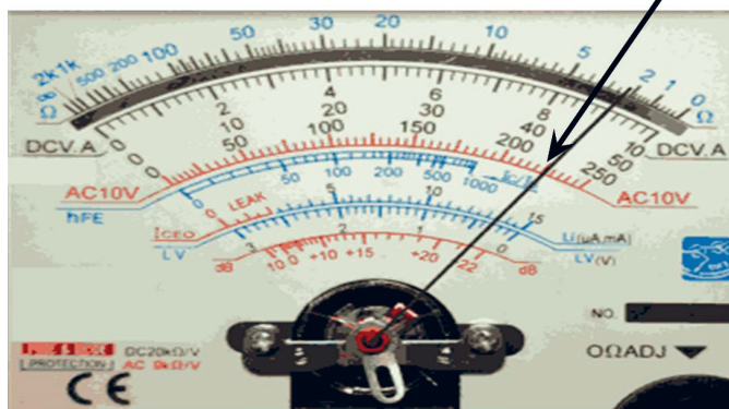
รูปที่ 1.16 เข็มวัดของมิเตอร์ตรงที่ชี้ 225 โวลต์
