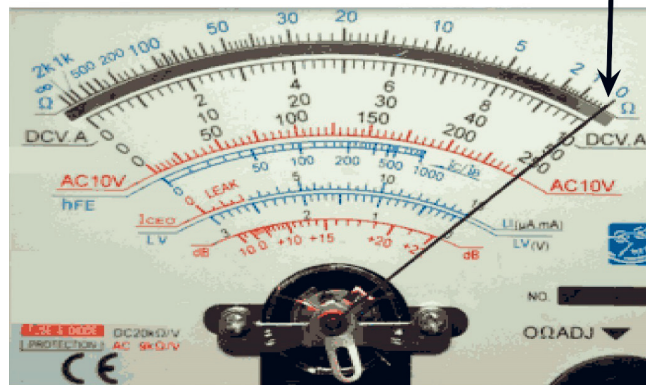
รูปที่ 1.6 ปรับเข็มวัดให้ทับ 0 Ω ทุกครั้งที่เลือกย่านการวัดใหม่
