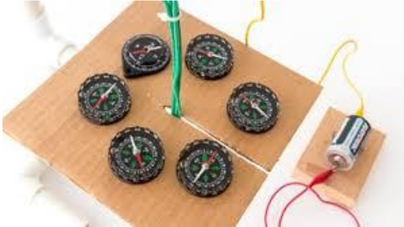
รูป 15.6 การทดลองที่แสดงให้เห็นว่าเส้นลวดที่มีกระแสไฟฟ้าจะมีสนามแม่เหล็กแผ่ออกมาโดยรอบ
