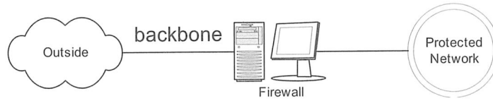
แผนภาพที่ 6 หลักการ Firewall
