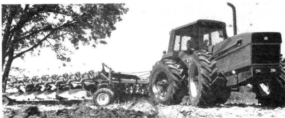
รูปที่ 2.30 แทรกเตอร์ขับเคลื่อน 4 ล้อ โดยช่วงกว้างของล้อออกแบบให้สามารถปรับระยะได้
