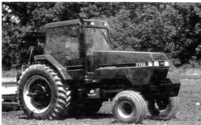
รูปที่ 2.12 แทรกเตอร์แบบเพลาล้อหน้ากว้างและปรับขยายระยะห่างของล้อได้
