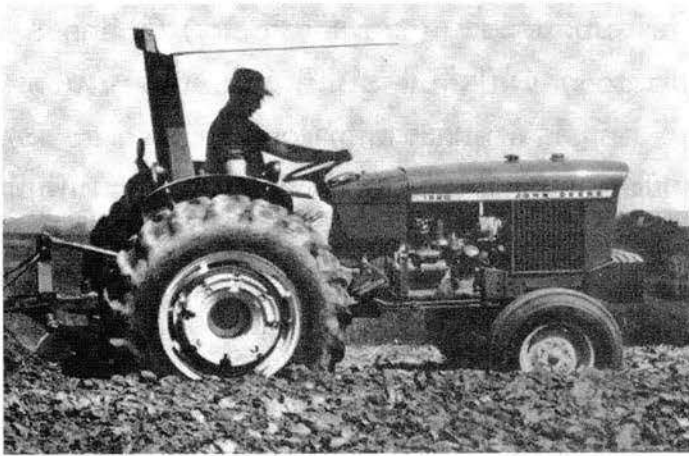
รูปที่ 2.6 โครงเหล็กสำหรับป้องกันคนขับ ขณะรถหมุนกลับหรือพลิกคว่ำ
