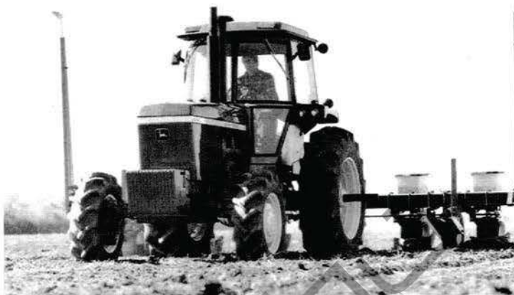
รูปที่ 2.22 แทรกเตอร์ขับเคลื่อน 4 ล้อโดยที่ล้อหน้าเป็นล้อช่วย
