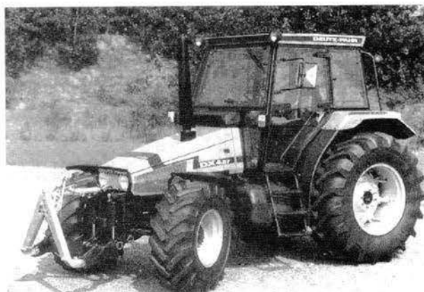
รูปที่ 2.31 แทรกเตอร์ที่ออกแบบให้มีแขนยกอยู่ด้านหน้า
