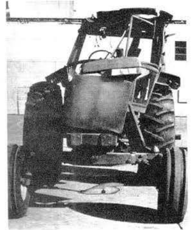
รูปที่ 2.7 ขณะเกิดการหมุนกลับหรือพลิกคว่ำ โครงเหล็กต้องแข็งแรงและต้องไม่ยุบลง
