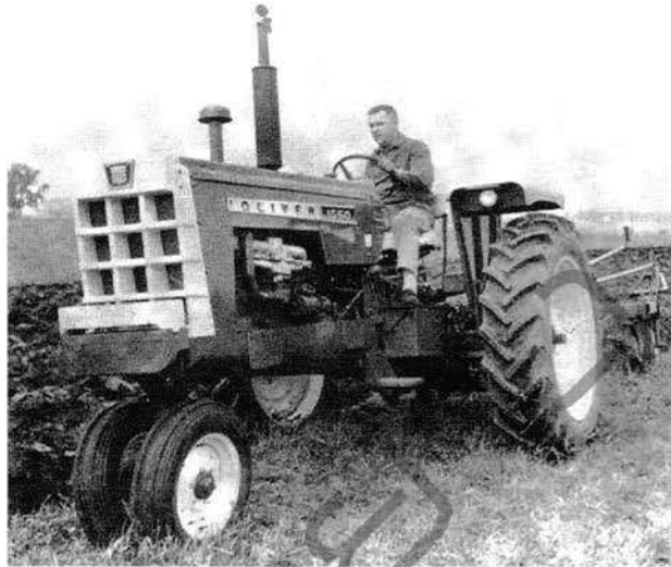
รูปที่ 2.11 แทรกเตอร์ที่ใช้สำหรับพืชที่ปลูกเป็นแถว
