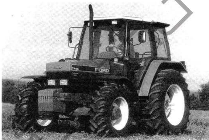
รูปที่ 2.8 การออกแบบห้องคนขับโดยอาศัยโครงเหล็กป้องกันการหมุนกลับหรือพลิกคว่ำ
