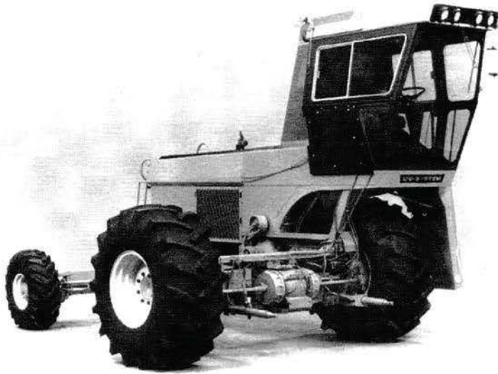
รูปที่ 2.19 แทรกเตอร์สำหรับขนย้ายเครื่องมือและอุปกรณ์
